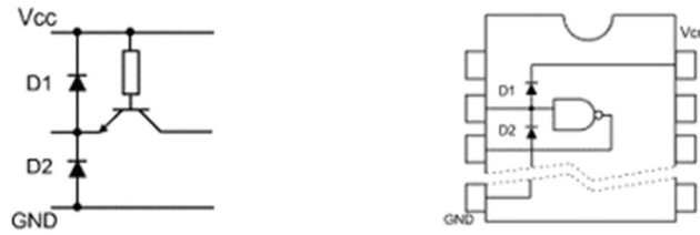
Şekil 2. IC pinlerindeki koruma diyot yapıları.
